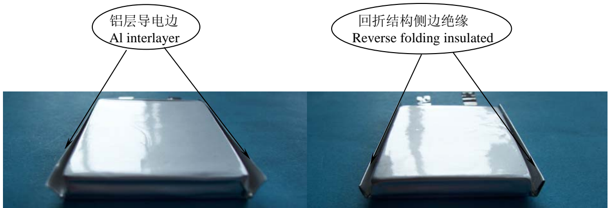
图 2: 锂聚合物电芯单层折边示意图 Single folding edge schematic of PL cells
