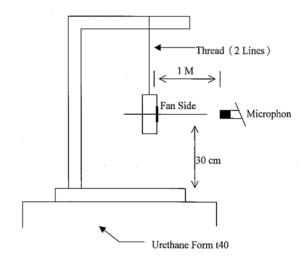
1 METER FROM MICROPHONE TO FAN INTAKE
